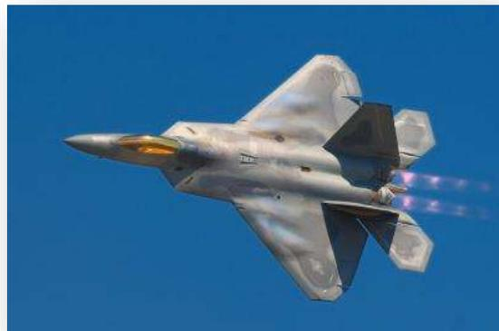
Les Ailes « Trapézoïdales »
