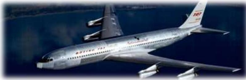
Cet avion va révolutionner le transport aérien et sera construit en 9000 exemplaires ! Sa forme est celle de quasiment tous les avions de transport de passagers depuis lors (ailes en flèche, réacteurs séparés et disposés sous la voilure).
